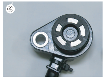
④5か所の接点をパーツクリーナーで洗浄します。
