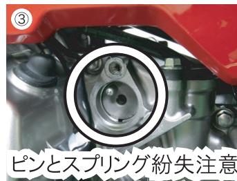
③ギアポジションセンサーを取り外します。
