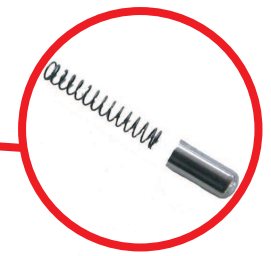
⑤赤丸で囲った部分のピンとスプリングを取り外し、スプリングを数ミリ伸ばしテンションを強くする事で接触が良くなり表示不良の改善になります。
