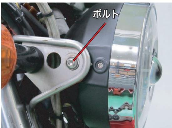
②左右方向への調整は、下の画像のナットを緩めてLED灯体を左右に動かして調整します。
