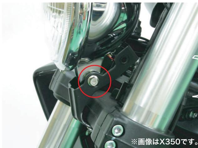
取り付け後はLED対応のヘッドライトテスターにて光軸の調整を行ってください。
