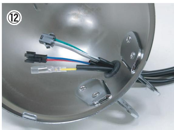
⑬ 引き込んだ黄コードとヘッドライトケース内のハイビームインジケータの黄コードを接続します。
