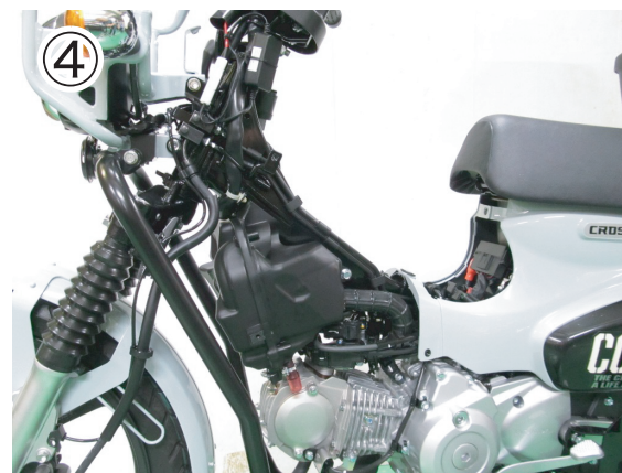
④①～③の外装カバーが全て取り外された状態
