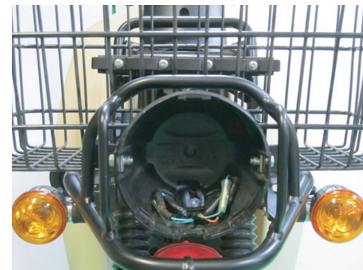
⑥ヘッドライトレンズ下の2本のネジを外してヘッドライトを外します。
