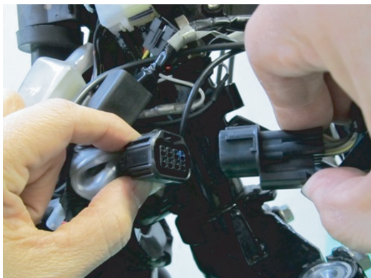
⑤キーシリンダー下にあるヘッドライトハーネスの防水黒8Pコネクターを分割しておきます。
