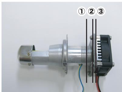
本製品は効率の良い放熱効果を得る為に、メーカー工場より出荷時に左の画像の①～③で示したLEDバルブの各パーツの接合部に、導熱用グリスが塗布されております。
