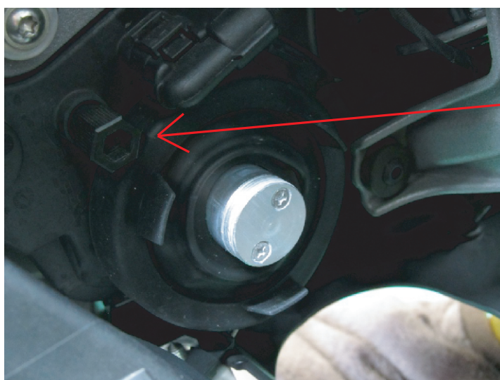
上下方向の光軸調整ネジ
