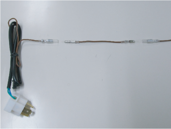
①ヘッドライト接続ハーネスの両端がオスギボシの配線を抜きます。
