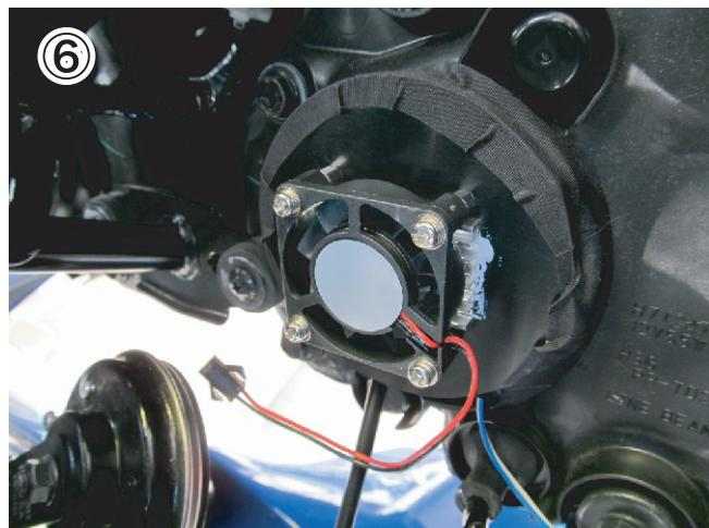
防水冷却ファンには指定の向きで取付けます。画像①の様に銀色のシールが外側を向く様に取付けしてください。
