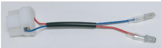
※変換ハーネスの車両側コネクター形状が車種によって異なる場合は、上の画像の様に端子形状を変更するなどして接続します。
