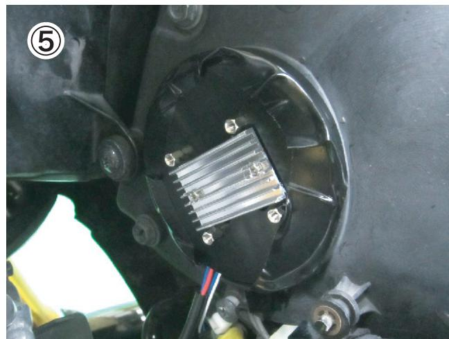
⑥ 防水冷却ファンをネジ留めします。ファンは銀色のシール面を外側に向けて取付けてください。
