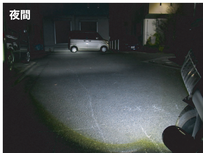
エンジン回転約2,000rpm以下のアイドリング停車中は減光点灯
