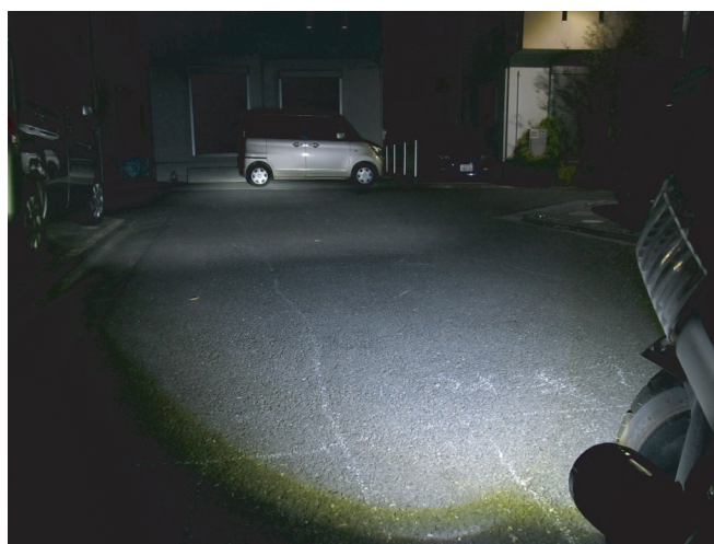
エンジン回転約2,000rpm以下のアイドリング停車中は減光点灯
