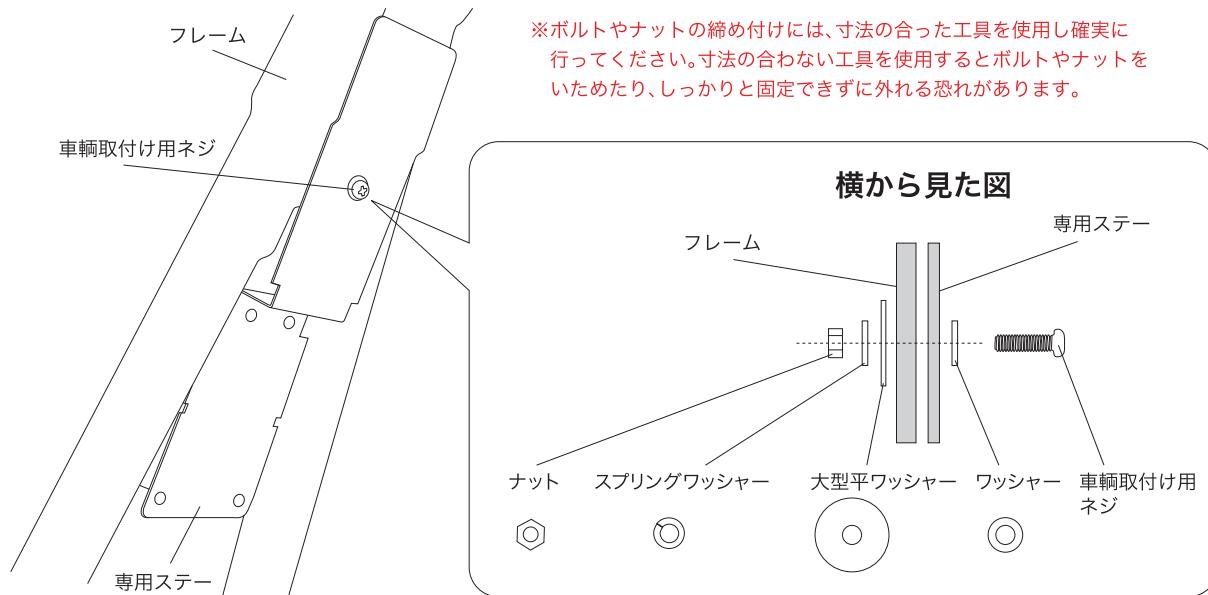
※フレームの専用ステー取付け穴の位置は型式により異なります。
