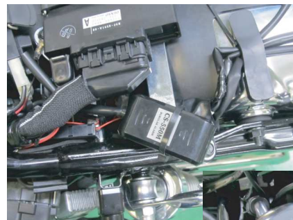
センサーはシート下に取付けします。
