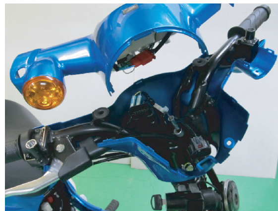
⑥ミラー左右と左ウインカーを外して ハンドル周りのカバーを上下に分割します。
