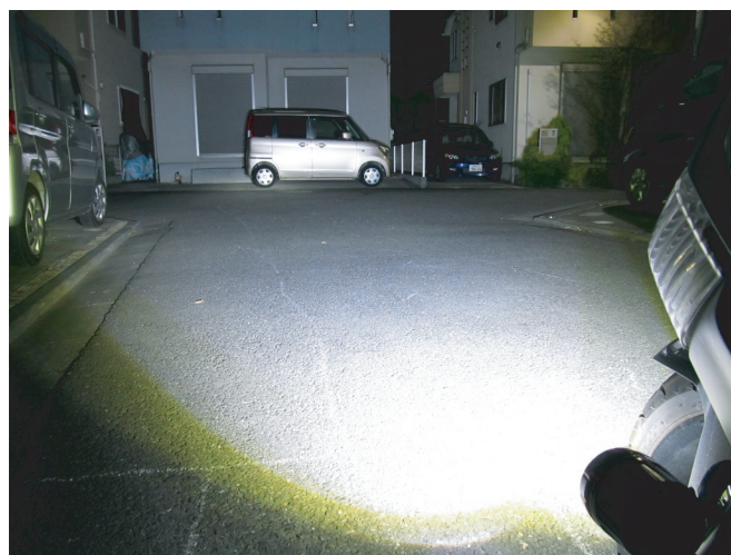
エンジン回転約2,000rpm以上の走行中はフルパワー点灯
